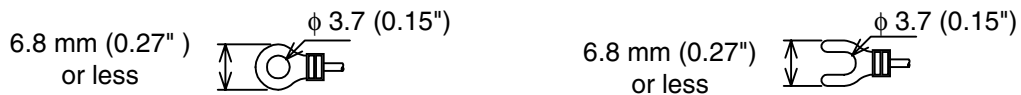
Figure 4.1: ENG ☞ Crimp Terminals for M3.5 Screws FRE ☞ Cosse de câble avec raccordement serti pour vis M3,5 GER ☞ Kabelschuhe mit Quetschanschluss für M3,5-Schrauben ITL ☞ Capocorda con collegamento a scatto per viti M3,5 ESP ☞ Manguitos de cable con conexión de apriete para tornillos M3,5
